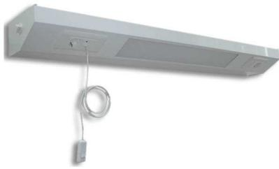
Светильник консольного типа ЛБО 08М состоит из двух частей - верхней и нижней: верхняя часть предназначена для общего, а нижняя для местного освещения палат больниц, госпиталей и других медицинских учреждений. В верхней части светильника используется одна люминесцентная лампа 58 Вт и стартер на 220 V, а в нижней части две люминесцентные лампы по 18 Вт и два стартера по 127 V.
