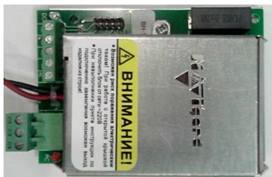
NV 7220 Импульсный источник бесперебойного питания
