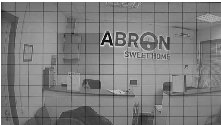
Рис.3.8 Установка области обнаружения движения
